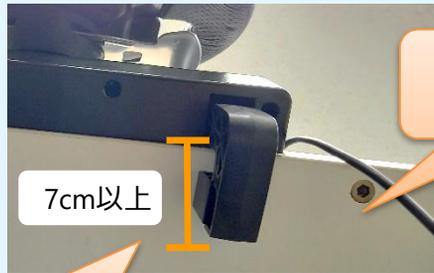
下面は凹凸のない、平らで滑りにくいもの (クランプで挟み込みます)
